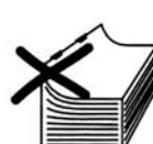
Papier zu dünn, Klammerung trägt auf
