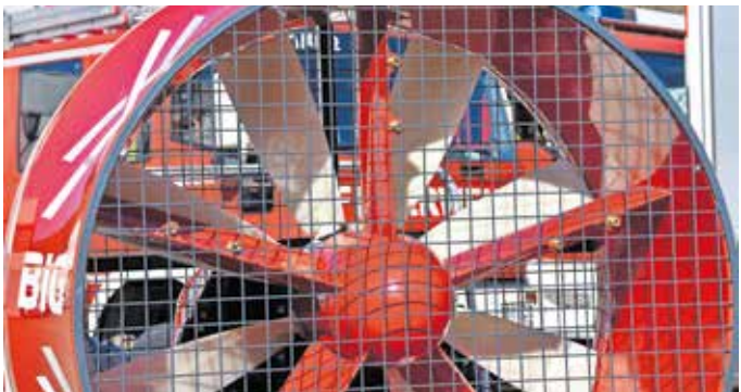
Ein neuer Großventilator kommt bei der Landauer Feuerwehr künftig bei Bränden in Tiefgaragen und Co. zum Einsatz.
