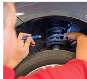
Einen Defekt am Stoßdämpfer können nur Fachleute zuverlässig erkennen. Fühlt sich das Auto beim Fahren schwammig an, kann das ein Indiz für verschlissene Dämpfer sein.
