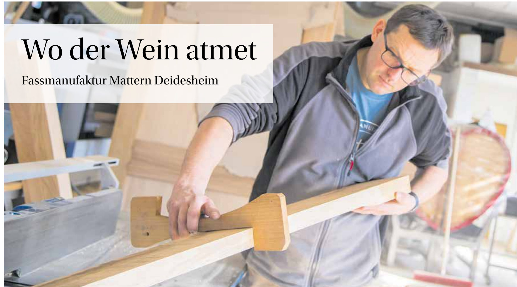
Ralf Mattern misst mit einer Schablone die Breite eines Bretts für ein Holzfass
